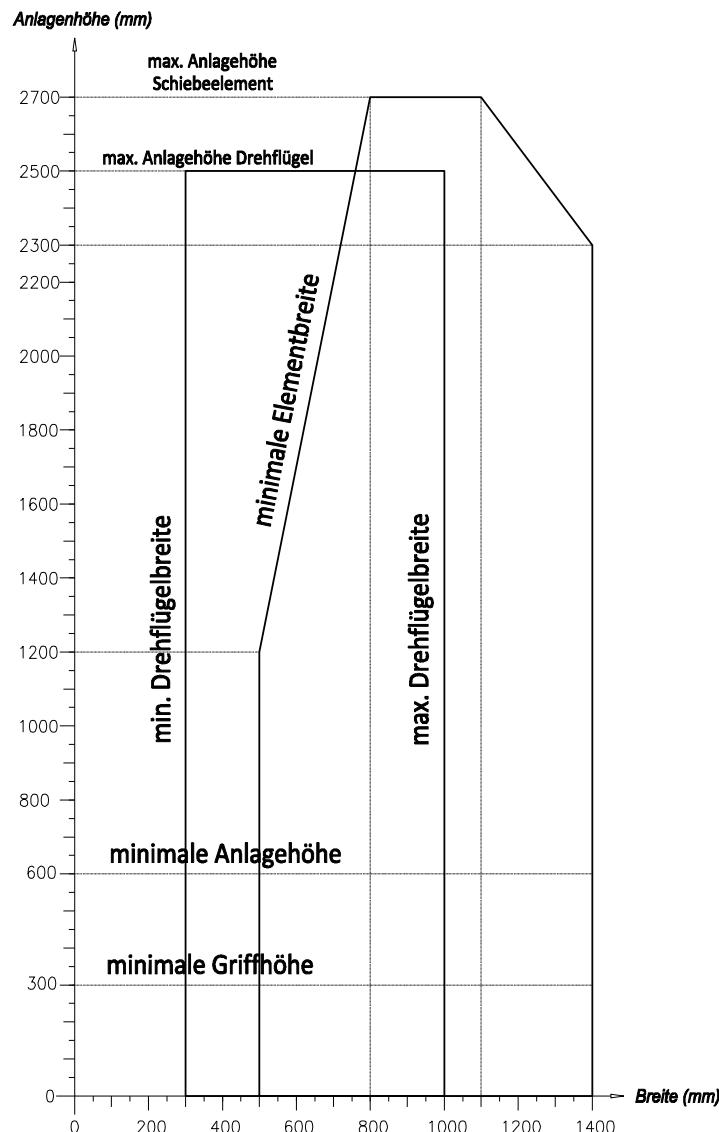
Dieses Element- und Flügel-diagramm bezieht sich auf die Anlagehöhe inklusive Rahmen, die Element- Flügel-breite entspricht jeweils Anlagebereite dividiert durch Anzahl Felder. Das Element- und Flügel-gewicht von maximal 70 kg muss bei der Dimensionierung beachtet werden.
