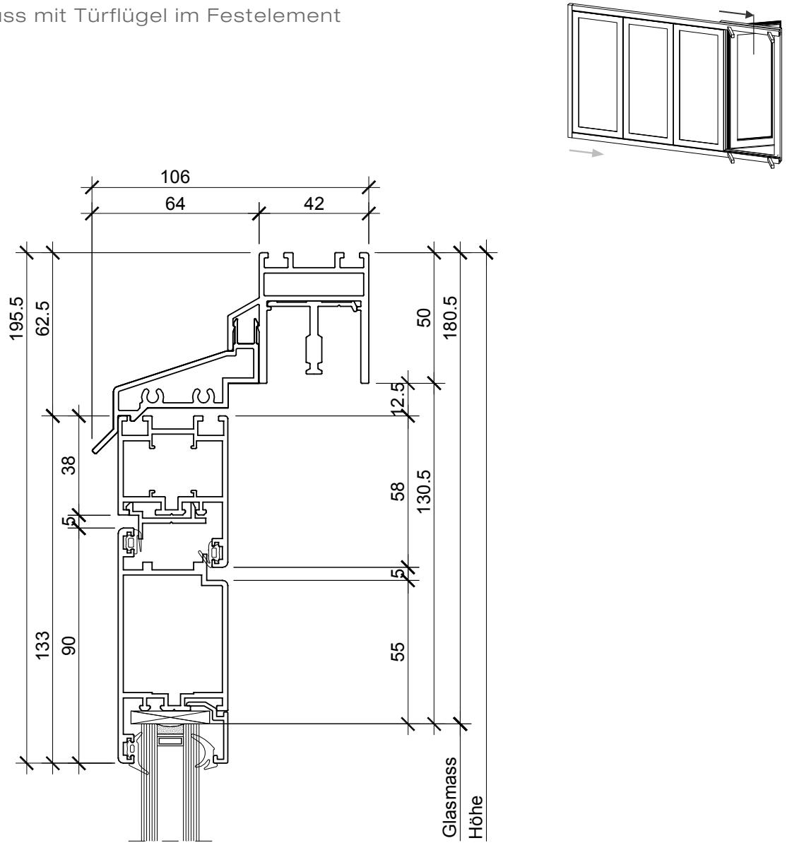
Bodenanschluss mit Türflügel im Festelement
